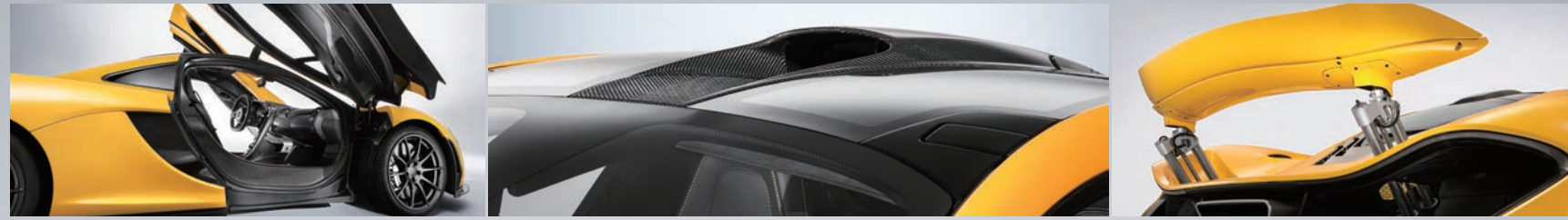
P1은 워든지 대단하다. 탑승 공간을 이루는 카본파이버 소재의 상자형 모노케이지의 무게는 90kg에 불과하고, 꼬리날개가 불쑥 솟아오르면 F1의 DRS와 같은 원리로 공기저항을 23%나 감소시킨다.
